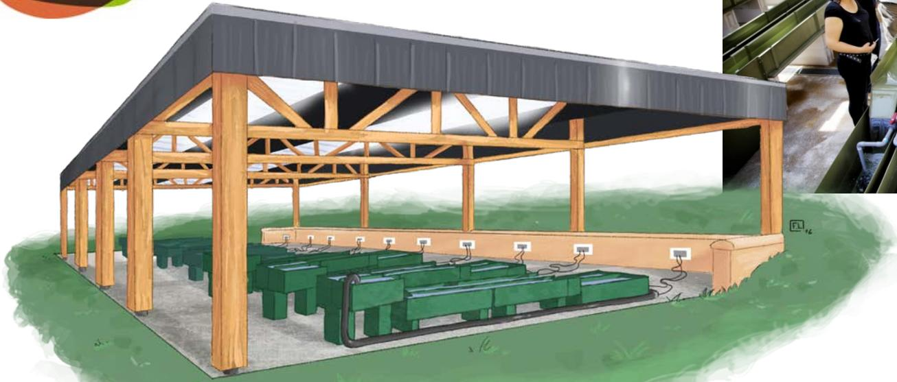
**Dispositif expérimental de 18 rivières artificielles
