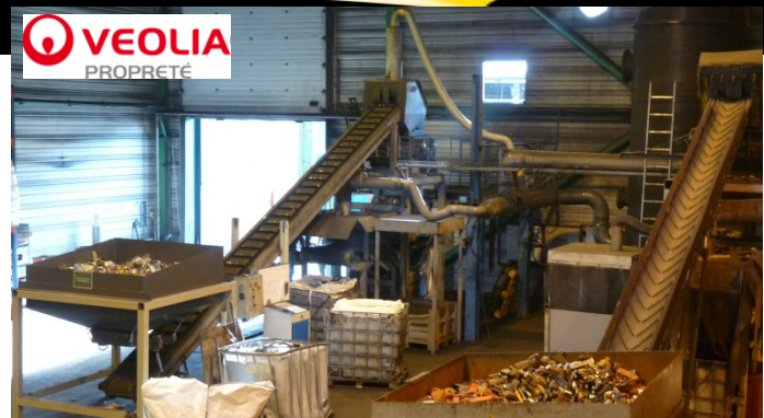
Unités de broyage de piles Zn/MnO 2 et de batteries NiCd d'EuroDieuze Industrie
