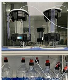
Des colonnes de laboratoires ont été acquises dernièrement par le GISFI pour effectuer des essais de percolation. D'un diamètre de 10 cm et de 30 cm de hauteur, elles présentent une échelle intéressante au laboratoire, pour des expérimentations en dynamique. Possibilité d'effectuer des essais de percolation selon les normes ISO/TS 21268-3 et NF EN 14405 et d'étudier le comportement à la lixiviation des sols ou autres matériaux granulaires. N'hésitez pas à nous contacter !
